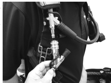
Connexion au connecteur d'alimentation de l'APRIA
