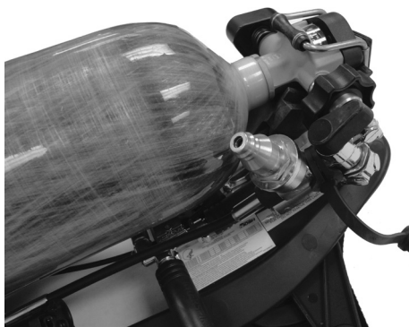
Bouchon anti-poussière de l'UAC retiré
