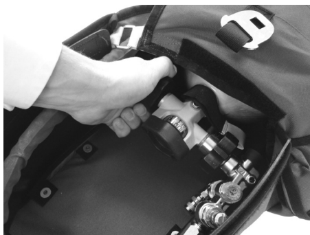
Ouverture du robinet de la bouteille
