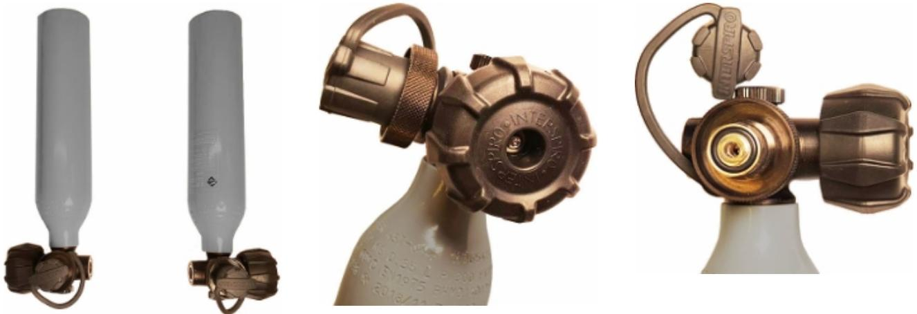
Die Divator- Inflatorflasche verfügt über ein Ventil, das in einem Winkel von 90 ° zur Flasche betätigt wird. Diese Konstruktion bietet ein sichereres Öffnungsverfahren im Vergleich zu herkömmlichen Inflatorflaschen. Durch Drehen in diesem Winkel wird verhindert, dass sich die Flasche selbst dreht, auch bei weiche Stofftaschen. Wenn Sie das Handrad drehen, sind Sie sicher das Ventil zu öffnen, anstatt nur die Flasche zu drehen.
