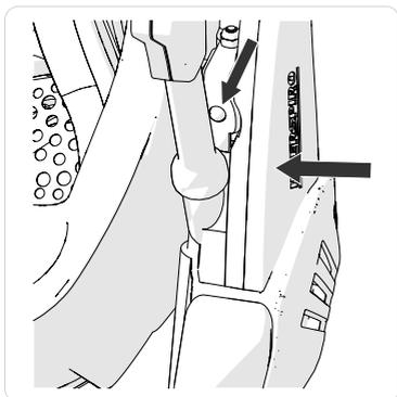
3. Versão com parafuso manual: premir o Spirocom contra a máscara até que seja possível apertar ligeiramente o parafuso manual no furo do suporte de fixação.
