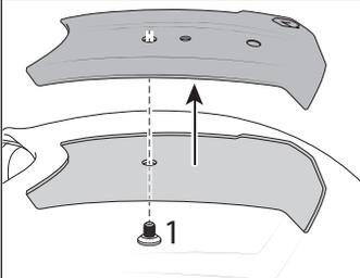
1. Entfernen Sie die Schraube an der Innenseite des Helms, die die Helmbefestigungsplatte hält.
