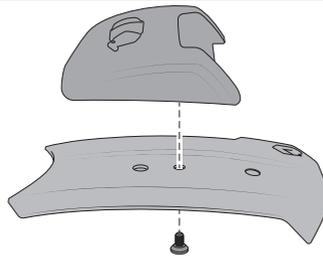
2. Montieren Sie die Helmadapterbefestigung mit einer Schraube an der Helmbefestigungsplatte.
