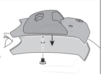
3. Montieren Sie die Helmbefestigungsplatte mit der montierten Adapterbefestigung am Helm.
